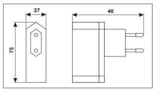
АЗУ предназначены для зарядки свинцово-кислотных и литий-ионных аккумуляторных батарей малой мощности в составе аккумуляторных профессиональных фонарей ЭКОТОН.
